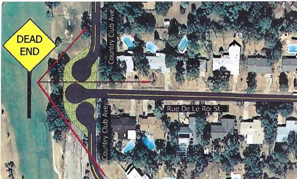
Figure 10. Cul-de-sac at Rue De Le Roi Street
